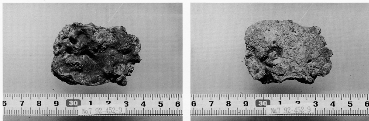
精練椀型鉄滓、原料砂鉄？ (資料 14)
