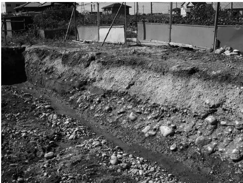
図 3-84 05B 区北壁西部における基盤礫層の露出状況
