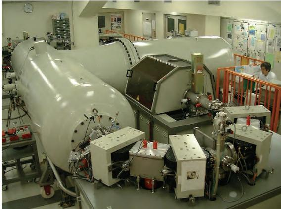
写真 13 オランダ High Voltage Engineering Europe (HVEE) 社製のタンデトロン 3MV-AMS システム
