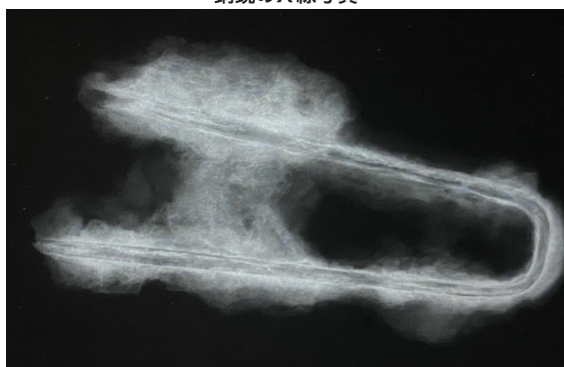
繊維が付着している鉄製品のX線写真
