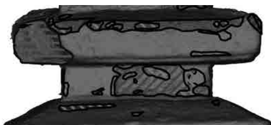
図8 Illustratorで損傷図の整理
