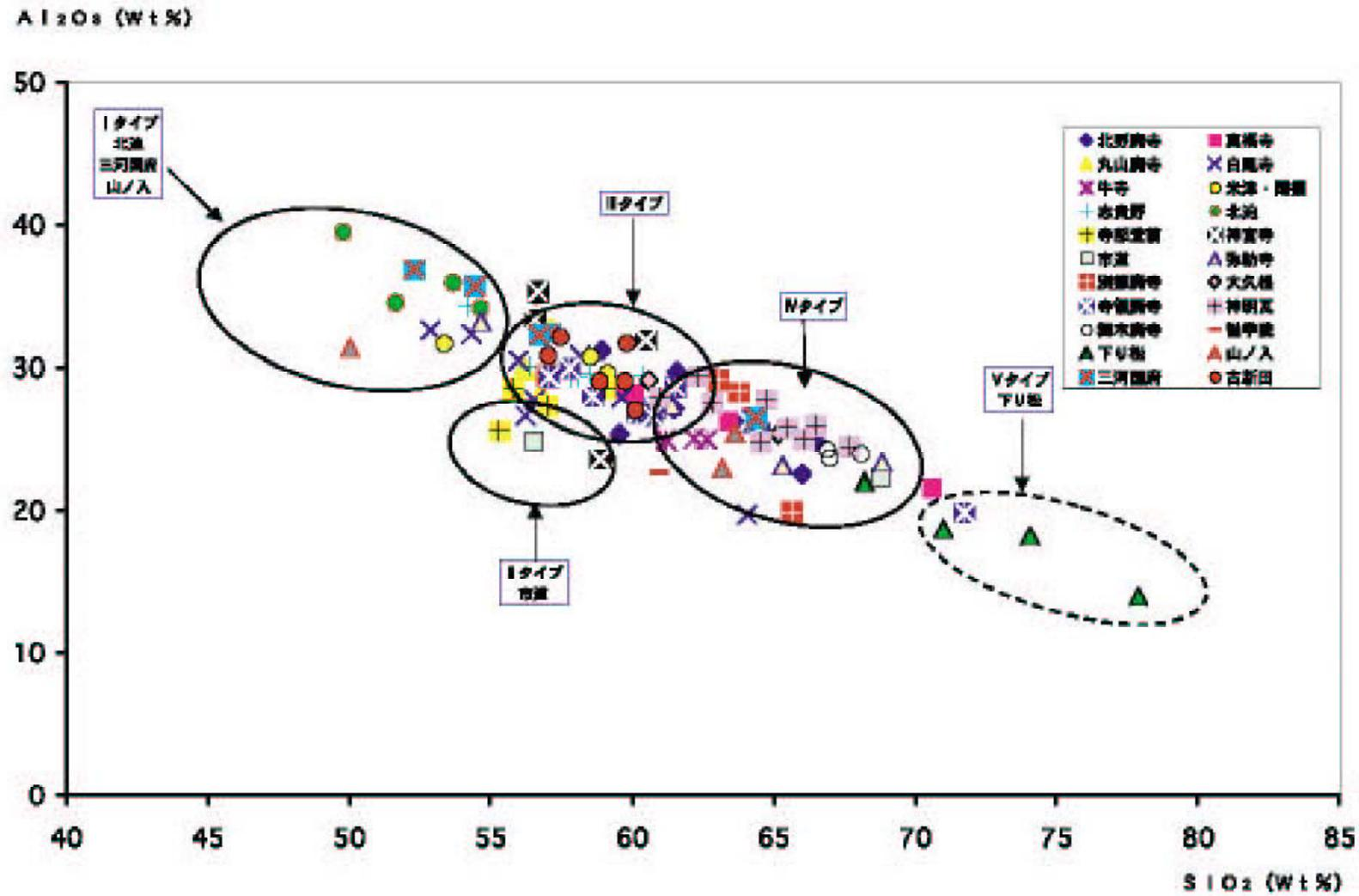
第108図 SiO<sub>2</sub>-Al<sub>2</sub>O<sub>3</sub>図 (丸瓦)
